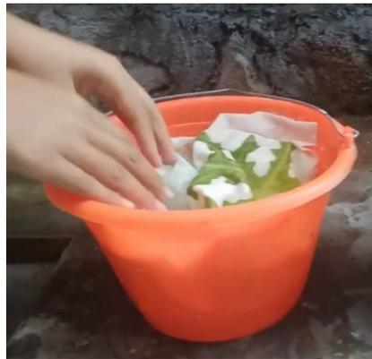
Gambar 4 merupakan proses pencelupan kain kedalam air larutan tawas. Kain yang telah selesai ditumbuk atau dicetak dengan batang, daun, bunga, selanjutnya akan dicelupkan kedalam air larutan tawas, hal ini bertujuan agar bentuk motif dan pigmen warna dari batang, daun, bunga, lebih awet atau tahan lama, serta bertujuan untuk membersihkan bekas-bekas penumbukan batang, daun, bunga, yang menempel atau tembus di kain tersebut.
