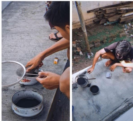
Gambar 4 Menumbuk Dan Menyaring Bonggol yang sudah dibakar
