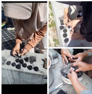
Gambar 7 Pencetakan Briket Bonggol jagung
