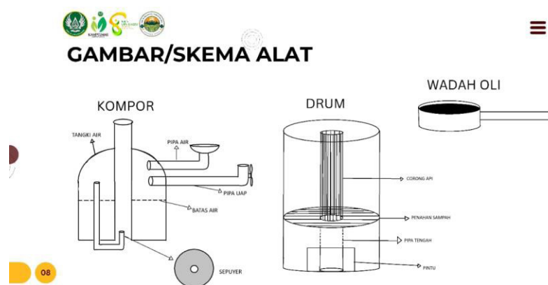
Gambar 1. Skema Pembuatan Incinerartor Drum Penggunaan incinerator drum dilakukan melalui beberapa langkah:
