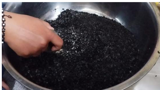
Gambar 3 Proses Penghalusan Kulit Kopi dan Pencampuran Tepung Tapioka Sumber: Penulis, 2025
